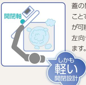
蓋の開閉軸を図のように設計することで、左右どちらからも蓋の開閉が可能です。設置場所の状況により左向き、右向きをお選びいただけます。
