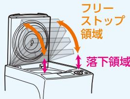
遠心室ドアは軽く電源が入ってなくても開閉可能、スムーズに作業をすることができます。さらにドアが急激に落下しない「フリーストップ」機構を採用。手を挟むなどのリスクを低減しました。
