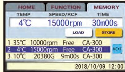
6通りの運転条件を記憶可能。一覧で表示するので希望条件の呼び出しが容易です。
