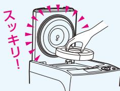
遠心室ドアパッキングがドア側に取り付けられていること、ドアフックがなくなったことにより、従来機と比較して遠心室へのアクセスが良くサンプルの取り出しやラックの脱着が容易です。
