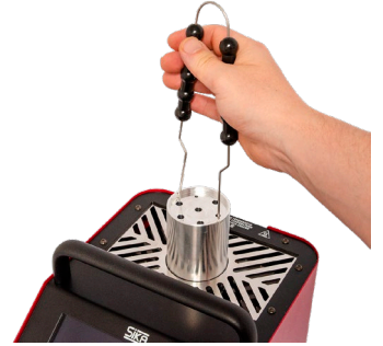
測定対象センサーに適合したインサートを入れるだけ
